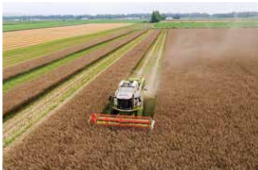
GPSを利用してしゅうかくするコンバイン
